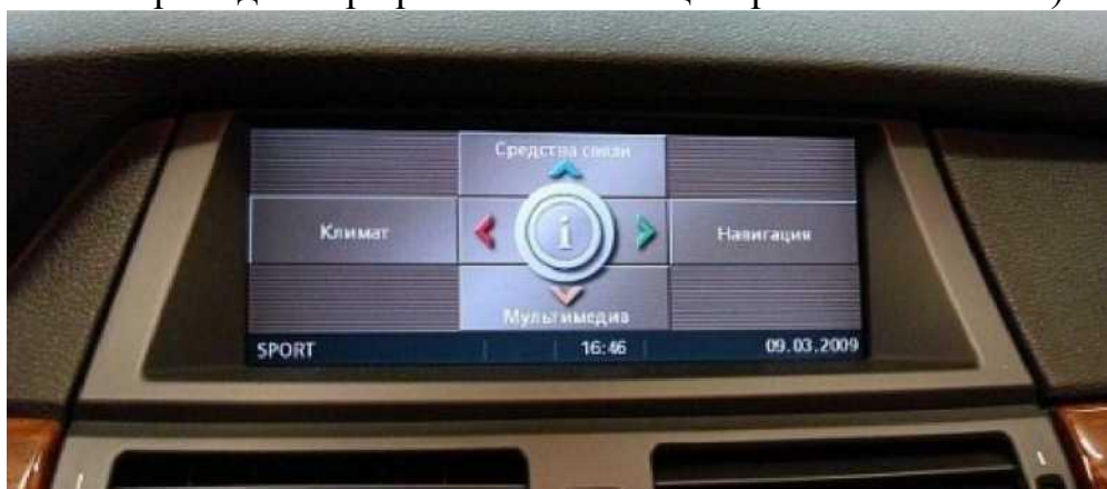
Рисунок 6 - Полная интеграция навигационного модуля в головное устройство
