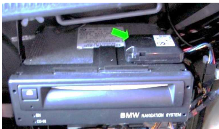
Рисунок 5 - Общий вид радиомодуля и навигационного компьютера автомобиля
