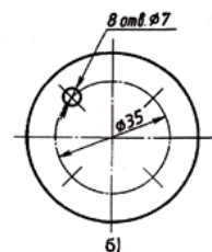
Рисунок 20. Нанесение размеров одинаковых отверстий, равномерно 2 мм под углом 45°.
